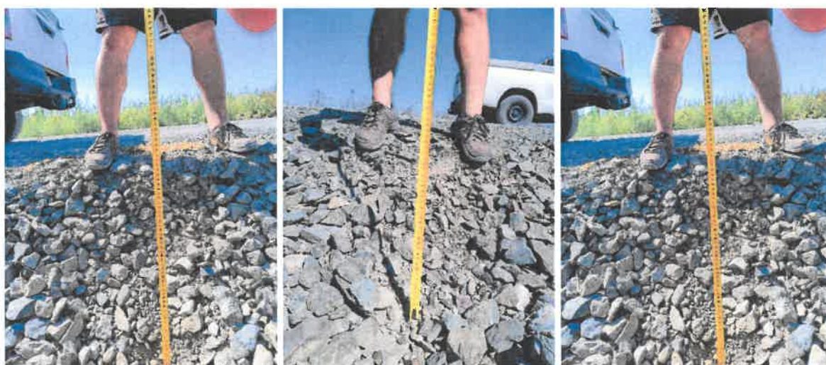
Figura 18. Determinare grosime structură rutieră
